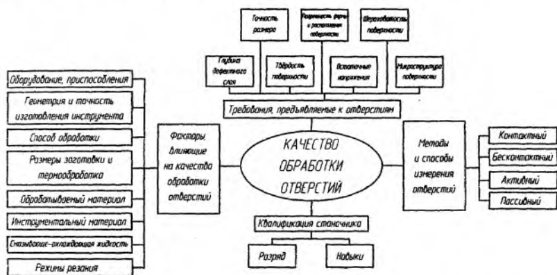
Рисунок 1 – Формирование качества обработки отверстий
