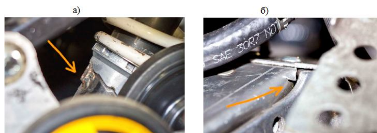
Сурет 3 – Қардажүргіштің жүріс бөлігінің бұзылуы: а) тіректерді кесу; б) рамадағы жарық
