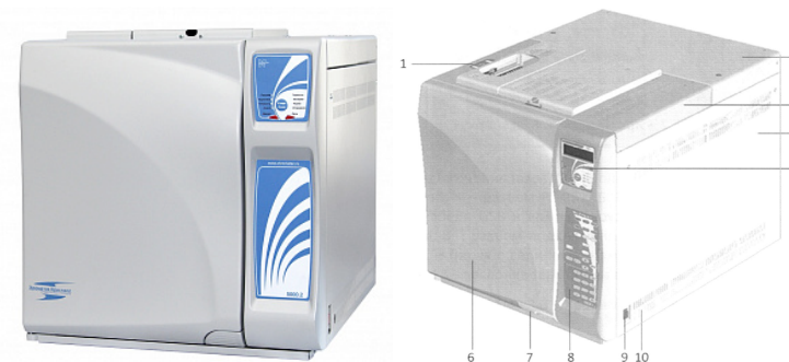
Сурет 2 - «Хроматэк-Кристалл 5000» хроматографының негізгі блогы:
