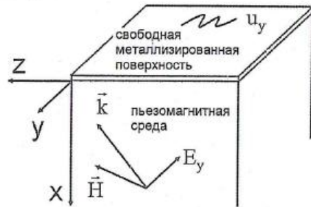
Рисунок 1. Кристаллографическая система координат пьезомагнитной среды гексагональной симметрии классов 6'22' , 6'mm' , 6'm'2 совмещена с декартовой системой координат
