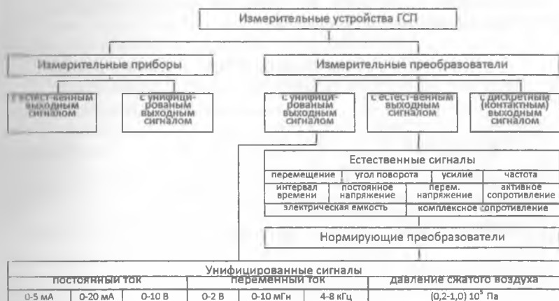
Рисунок 2.4 – Структура измерительных устройств ГСП
